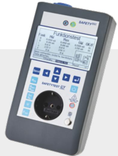
Die Kompakttester Safetytest 1LT V2 und 1PM besitzen den vollen Funktionsumfang zum Prüfen nach DIN VDE 0701 und 0702. Die Bedienung über die Test-Master App oder die Remote-Master App bietet effizient geführte Prüf Abläufe und ein exzellentes Prüfdatenmanagement.
